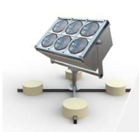
Suntracker leiten das Tageslicht über Fresnellinsen – also großflächige Stufenlinsen aus Kunststoff – in den Innenraum und speisen die Lichtleiter
