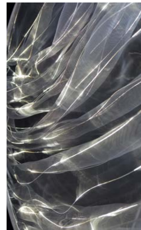
Suntracker leiten das Tageslicht über Fresnellinsen – also großflächige Stufenlinsen aus Kunststoff – in den Innenraum und speisen die Lichtleiter
